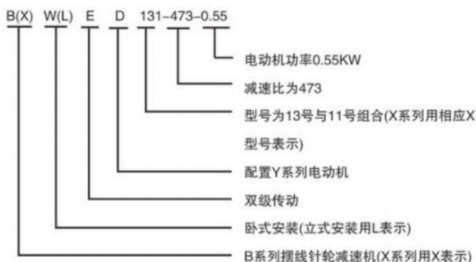
摆线针轮减速机型号对照表 (承载能力)
