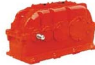
硬齿面圆柱齿轮减速机 Hardened cylinder gear reducer 底脚安装，共九种装配形式，可配逆止器，满足单向旋转需要，可配大功率，实现高承载能力 传动比：单级1.25~6.3 双级6.3~20 三级22.4~100
