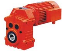
平行轴斜齿轮减速机 Parallel shaft helical gear reducer 可底脚、法兰、空心轴安装 可配各类电机或双轴型 功率：0.12~200kw 转矩：200~18000N.m 传动比：4~31500
