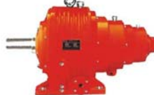
NGW-S伞齿轮行星减速机 NGW-S umbrella gear planetary gear 速比范围：两级11.2~80 三级56~500 输入轴转速：750~1500rpm 输入功率：双级2.33~563.6kw 三级1.5~199.5kw 输出扭矩：双级1910~49714N.m 三级7820~68310N.m
