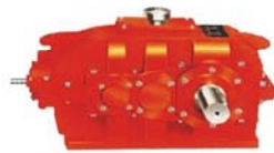
硬齿面圆锥圆柱齿轮减速机 Hardened tapered cylindrical gear reducer 底脚安装，分实心轴和空心轴或带收缩盘联接可配逆止器，满足单向旋转需要可配大功率，实现高承载能力 传动比：二级8~14 三级16~50 两种旋向，四种装配型式
